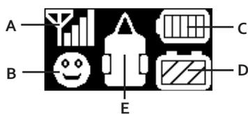
**(A) Signalstärke** - Zeigt die Signalstärke zwischen Fernbedienung und Steuereinheit an
